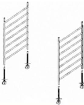
Die beiden Leiterrahmen 130/200 werden an den untersten Sprossen mit Horizontalstreben 250 verbunden, aufgestellt und gegen umfallen gesichert. Wenn Ausgleichsgewichte benötigt werden (siehe Aufbauvarianten Dreiecksausleger), kann auf der untersten Sprosse an einer Seite eine Plattform ohne Luke 60/250 statt der Horizontalstrebe 250 eingehängt und gesichert werden. Auf der gegenüberliegenden Seite muss eine Horizontalstrebe 250 verbaut sein.
