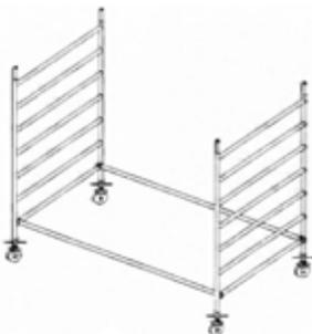
Mit Hilfe einer Wasserwaage wird nun durch das Verstellen der Spindelhöhe der Räder das Gerüst in ihrer Waagrechten und Lotrechten ausgerichtet.
