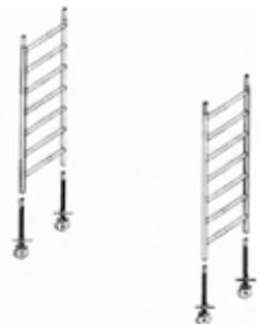
Die beiden Leiterrahmen 70/200 werden an den untersten Sprossen mit Horizontalstreben 250 verbunden, aufgestellt und gegen umfallen gesichert. Wenn Ausgleichsgewichte benötigt werden (siehe Aufbauvariante Dreiecksausleger), kann auf der untersten Sprosse an einer Seite eine Plattform ohne Luke 60/250 statt der Horizontalstrebe 250 eingehängt und gesichert werden.
